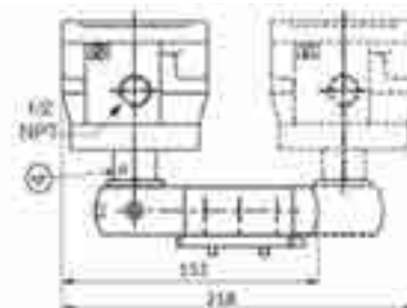
- катушка NF алюминиевый корпус (WS)NF - II2G Ex d IIC T6/T5/T4, II2D Ex t
